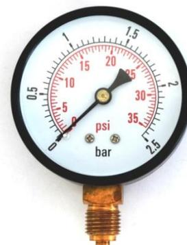
**Materiais:** Caixa: Aço pintado de preto; Aro: Aço com acabamento a preto ou Aço inox para fixação por flange ou U-clamp; Espelho: vidro; Mostrador e ponteiro: alumínio com acabamento a branco; Mecanismo: Latão e bronze fosforoso; Restritor: standard em toda a gama; Aplicações: para medição de pressão em vapor, air, óleo, água e outros fluidos compatíveis com bronze e com latão.
