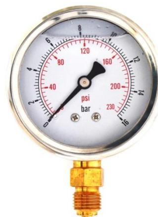
**Materiais:** Caixa e Aro: Aço AISI 304; Espelho: Vidro Policarbonato; Mostrador e Ponteiro: Aço com acabamento a branco; Mecanismo: Latão e bronze fosforoso; Restritor: Standard em toda a gama; Aplicações: para medição de pressão em ambientes severos onde as pulsações e as vibrações são um problema. Vapor, air, óleo, água e outros fluidos compatíveis com bronze e com latão.
